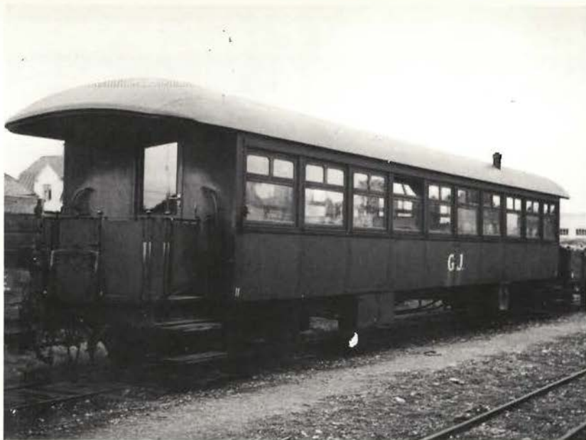
Gotlands Järnvägs verkstad tillverkade fyra boggienvagnar. Den sista personvagnen över huvud taget som tillverkades för GJ var ovanstående vagn, GJ Co 11, som blev klar 1942. Den vägde 17.76 ton och hade en längd över buffertarna av 17.75 m. Vagnen hade 70 sittplatser. Foto i Visby 24 juli 1952, L. Welander.
